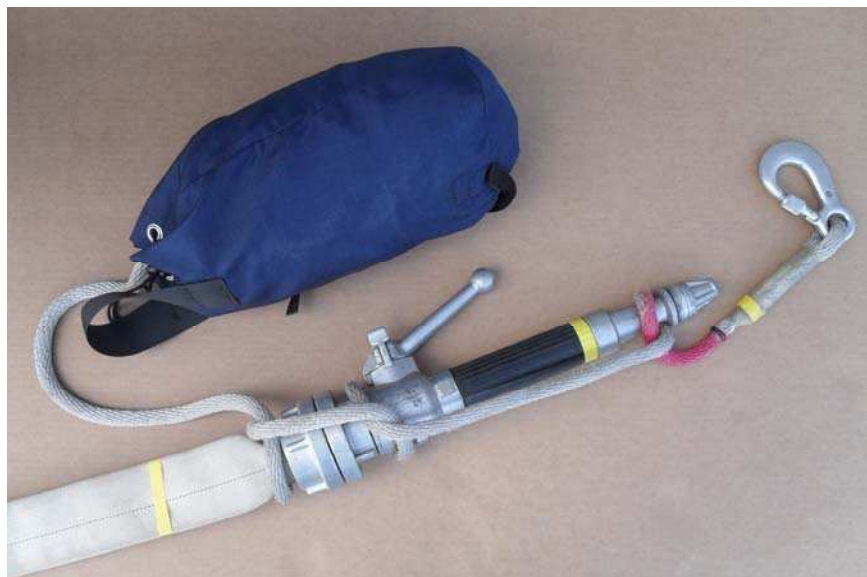
Aufziehen der Löschleitung - Strahlrohrknoten
